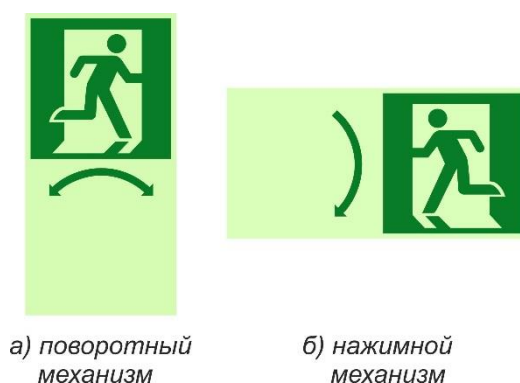
Рисунок 1 - Пример комбинированного знака для обозначения механизма замка и способа открытия двери.
