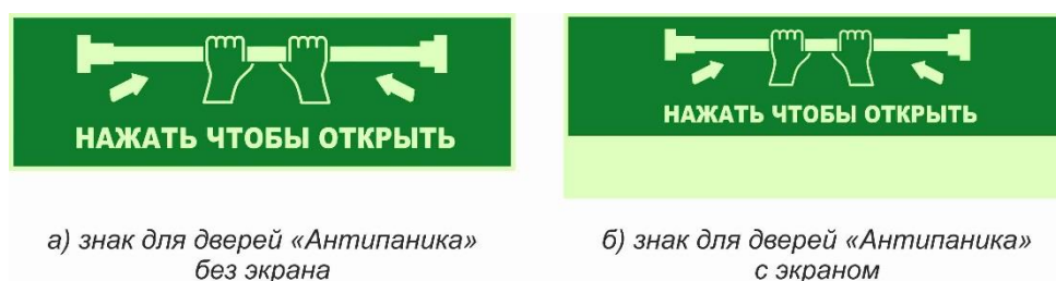
Рисунок 2 - Пример знака для обозначения механизма замка «Антипаника» и способа открытия двери
